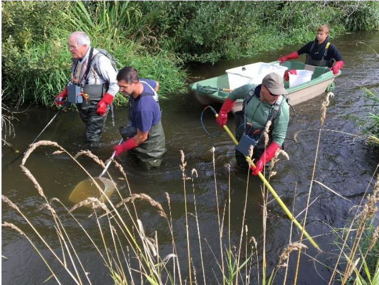
Abbildung 7: Elektrofischung im Forschungsprojekt InseGdA mit Prof. Lüderitz an der Eger (Foto: Dr. Oliver Kreß)
